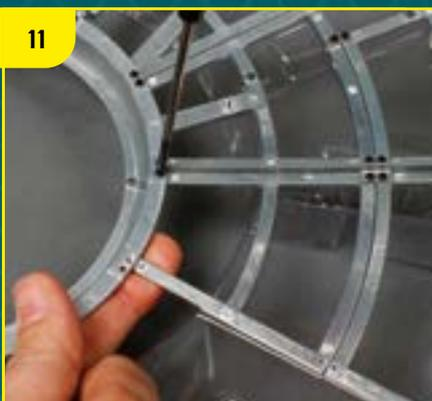
Зафиксируйте внутренний угол рамы TF-34, закрутив винт в кольцо турели.
