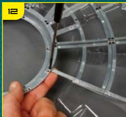
Зафиксируйте оставшийся угол рамы TF-34, закрутив винт в кольцо турели.
