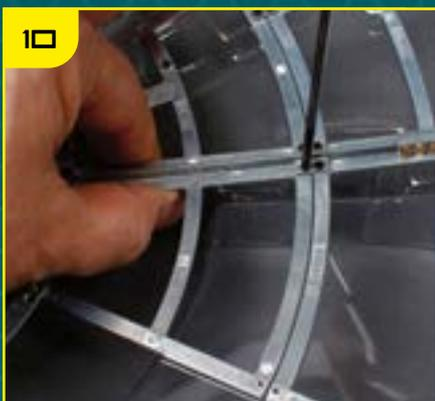
Зафиксируйте раму TF-34, закрутив винт во фланец ребра жесткости.
