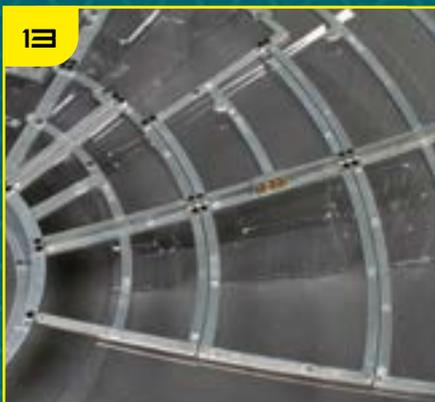
Внешние края рам TF-32, 33 и 34 будут зафиксированы на следующем этапе.
